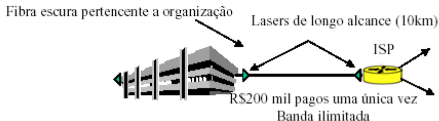
Condomínio: Conexões de fibra apagada do usuário para ISPs
